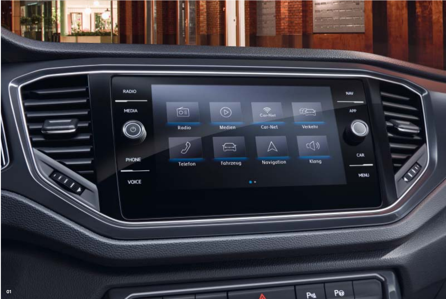
01 Навігаційна система Discover Media оснащена 20,3 см (8-дюймовим) кольоровим TFT-дисплеєм з сенсорним екраном та датчиком наближення руки. Модуль обладнано CD-про-гравачем з підтримкою MP3 і WMA форматів та вісьмома динаміками. Також система має два роз'єми для SD-карт, інтерфейси USB та AUX-IN і можливість з'єднання з мобільним телефоном через Bluetooth.
